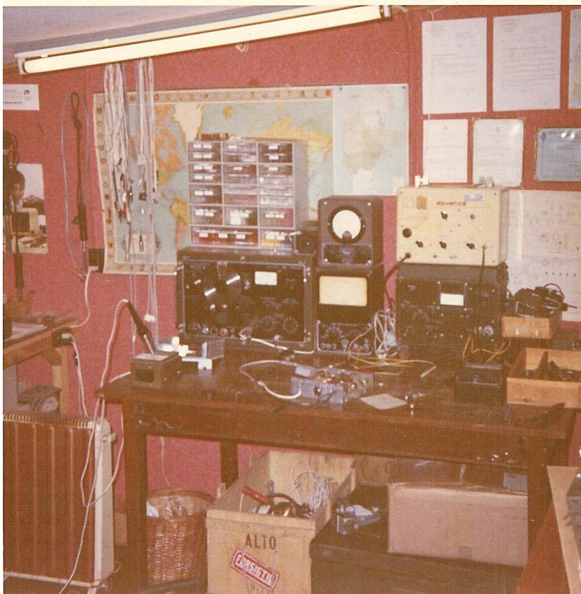
Billede af Hjemmeværnsdistrikt Himmerlands telegrafmekanikerudstyr fra omkring 1969. Til venstre ses Radiometer MS27 målesender. Til højre herfor Radiometer rørvoltmeter RV22 og ovenpå dette et HSGT outputmeter OP-56. Derefter nederst en DISA frekvensmåler M/51. ovenpå denne en gul Advance målesender. Det var en civil udgave, der var forsynet med en aluminiumsplade hvor på stod HSGT T-73
